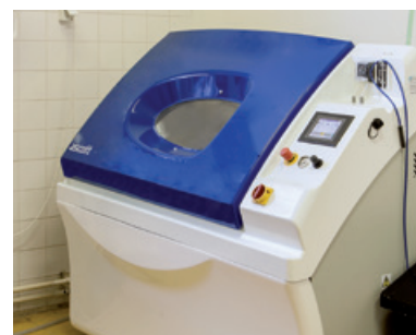
Korózna komora pre simuláciu extrémnych podmienok a testovanie materiálov.
