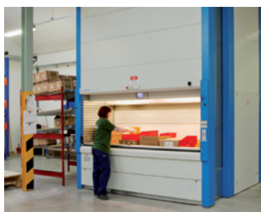
KARDEX. Veľkokapacitný automatizovaný skladovací systém.
