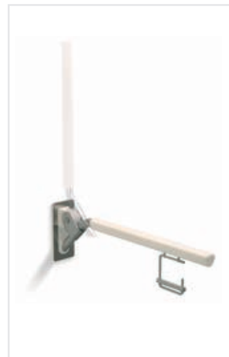
Sklopné držadlo k WC s držiakom toaletného papiera Lehen Evolution priemer 38 mm, skryté upevnenie matná antikorová oceľ, povrch držadla biela hladká pena PUR vrátane montážnej súpravy do muriva dĺžka 70 cm, L30412001 dĺžka 85 cm, L30413001
