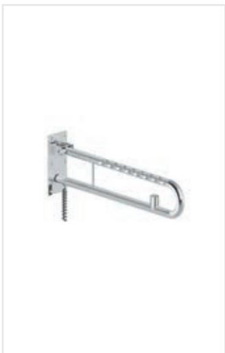
Sklopné držadlo k WC Lehen Funktion s tlačidlom elektrického splachovania priemer 32 mm antikorová oceľ vrátane montážnej súpravy do muriva dĺžka (rozstup) 70 cm zvlínený povrch L1070202
