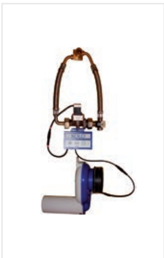
Automatický termický splachovač pisoárov pre napájanie z batérie 6V Lithium Prívod vody 1/2" prevádzkový tlak min./max. 1/10 bar teplota vody 4 – 30°C
