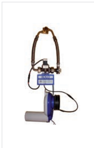
Automatický termický splachovač pisoárov pre napájanie z elektrickej siete 230 V AC Prívod vody 1/2" prevádzkový tlak min./max. 1/10 bar teplota vody 4 – 30°C
